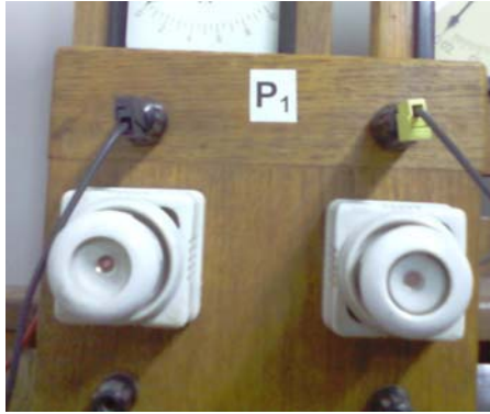
Сл.4 – Прекидач (P1) за прикључивање побудног напона на мотор
