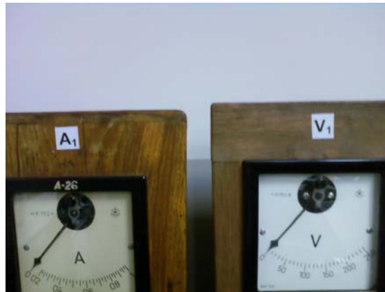
Сл.2 – Амперметар (A1) у побудном колу и волтметар (V1) у арматурном колу мотора
