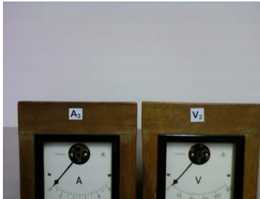
Сл.7 – Амперметар ( A_3 ) и волтметар ( V_2 ) у аматурном колу генератора
