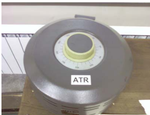
Сл.10 – Напојни аутотрансформатор (ATR)
