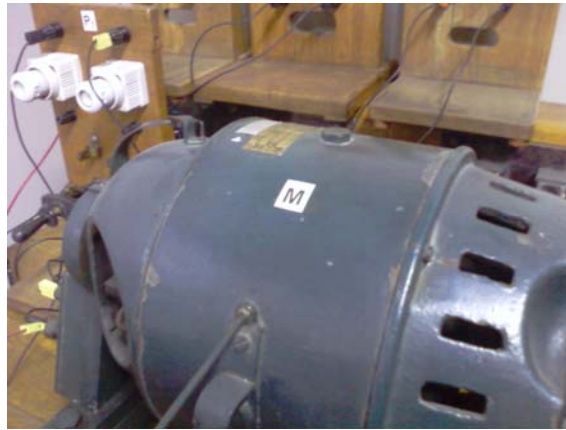
Сл.1 – Мотор динамометар (M)
