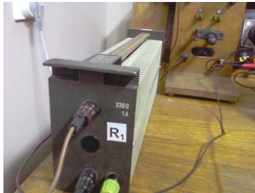
Сл.5 – Отпорник (R1) у побудном колу мотора
