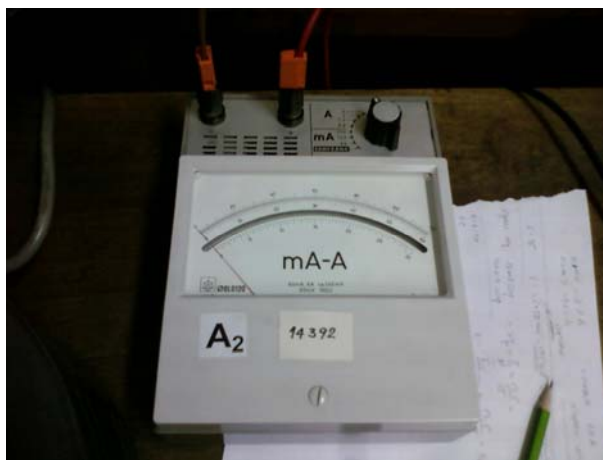
Сл.3 – Амперметар (A2) у арматурном колу мотора
